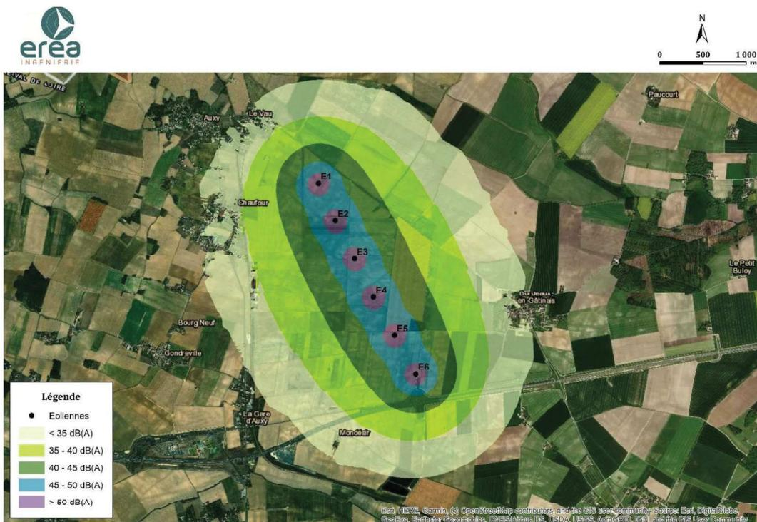
*Isophones pour l'implantation de 6 éoliennes de modèle E126 pour un vent de vitesse standardisée de 10 m/s*
