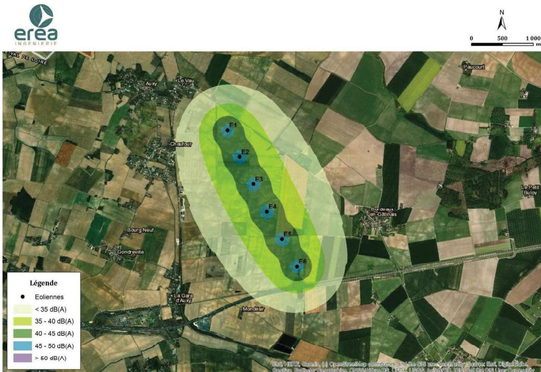
*Isophones pour l'implantation de 6 éoliennes de modèle E126 pour un vent de vitesse standardisée de 5 m/s*
